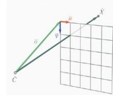
$$P = \begin{bmatrix} u_x & v_x & o_x \\ u_y & v_y & o_y \\ u_z & v_z & o_z \end{bmatrix}$$
